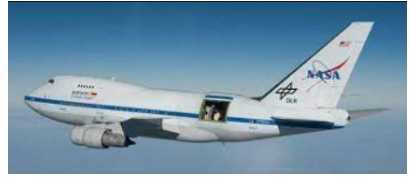
Aereo 747sp con il telescopio Sofia da 2,5 m (NASA)
